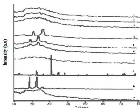
**Fig. 1:** XRD Pattern of a) Pure PVC, b) Pure PEO, c) Pure LiClO<sub>4</sub>, d) PVC – LiClO<sub>4</sub>, e) PVC (25%) – PEO (50%), f) PVC (37.5%) – PEO (37.5%), g) PVC (50%) – PEO (25%), h) PVC (25%) – PEO (50%) – LiClO<sub>4</sub>, i) PVC (37.5%) – PEO (37.5%) – LiClO<sub>4</sub>, j) PVC (50%) – PEO (25%) – LiClO<sub>4</sub>
